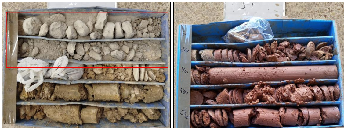
Imatge 4-1 A l'esquerra en el quadre vermell el paviment i el nivell de reblert. Per sota el substrat de lutites sorrenques marró vermelles amb nòduls de carbonat. Y graves de calcària.
