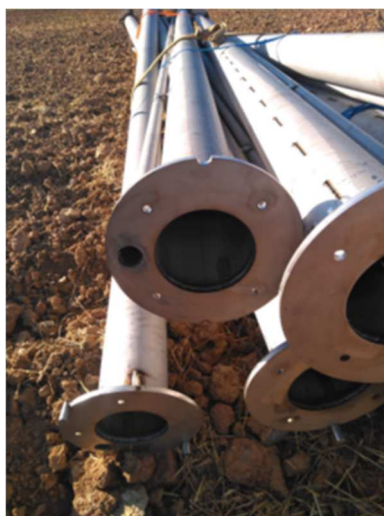
Exemple de canonada INOX de 160 mm mecanitzada i preparada per instal·lar a l'obra
