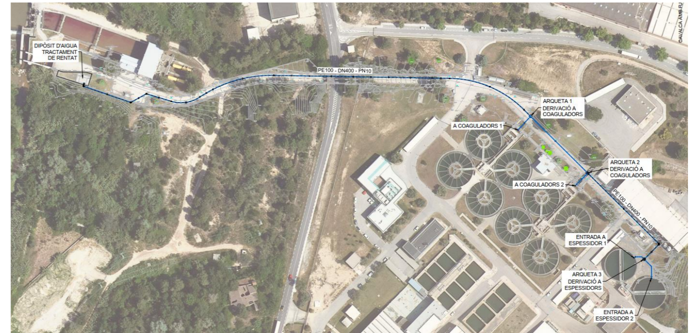
Figura 17: Impulsió de captació a zona decantadors/espessidors
