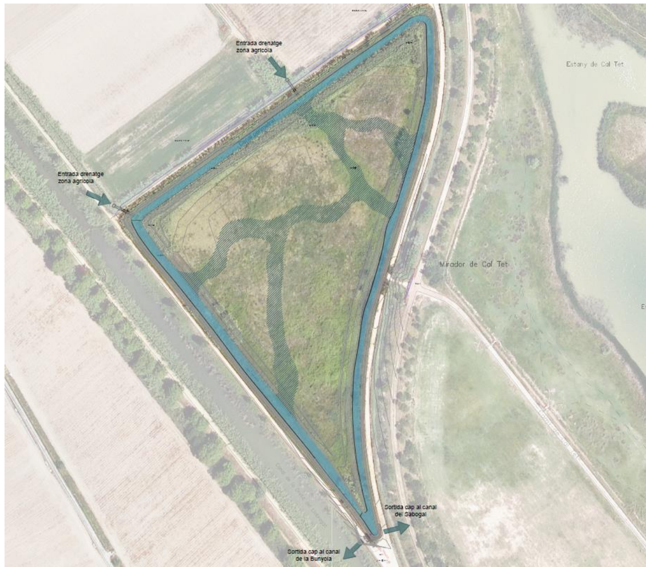
Figura 5 Sistema hídic. Canals de les obres de drenatge, zona excavada a la plana central i canal perimetral.
