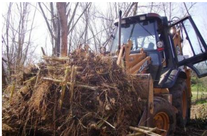
Figura 3 Procés mecànic d'eliminació de canya.
