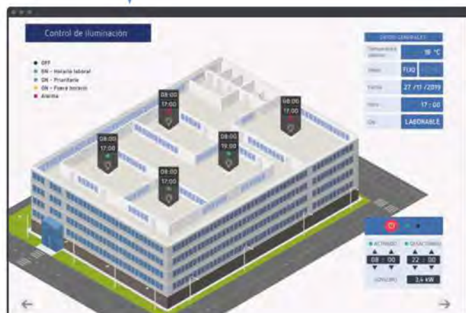
Ejemplo de control de iluminación
