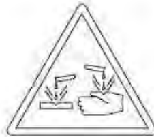
RIESGO DE CORROSION
