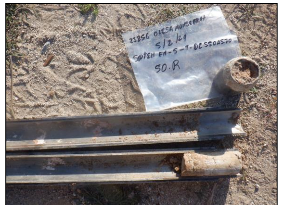
Foto 4: Sondeig S-1, SPT a 5,5 metres.
