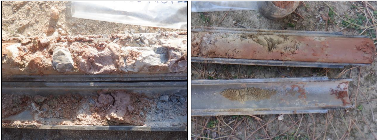
Assaigs SPT realitzats a la capa A més granulars (esquerra) i més cohesius (dreta).
