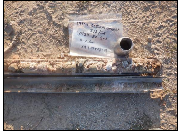
Foto 2: Sondeig S-1, SPT a 1,6 metres.
