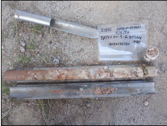
Foto 7: Sondeig S-2, SPT a 3,6 metres.
