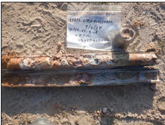
Foto 3: Sondeig S-1, SPT a 2,7 metres.
