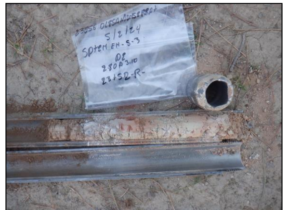
Foto 10: Sondeig S-3, SPT a 2,8 metres.
