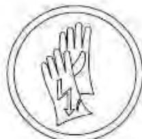
USO DE GANTES DIELECTRICOS
