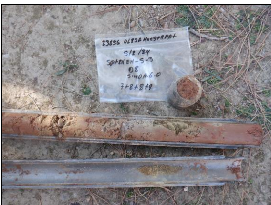
Foto 11: Sondeig S-3, SPT a 5,4 metres.
