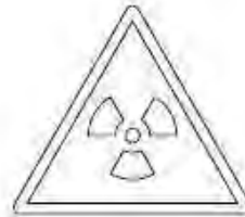
RIESGO DE RADIACIÓN
