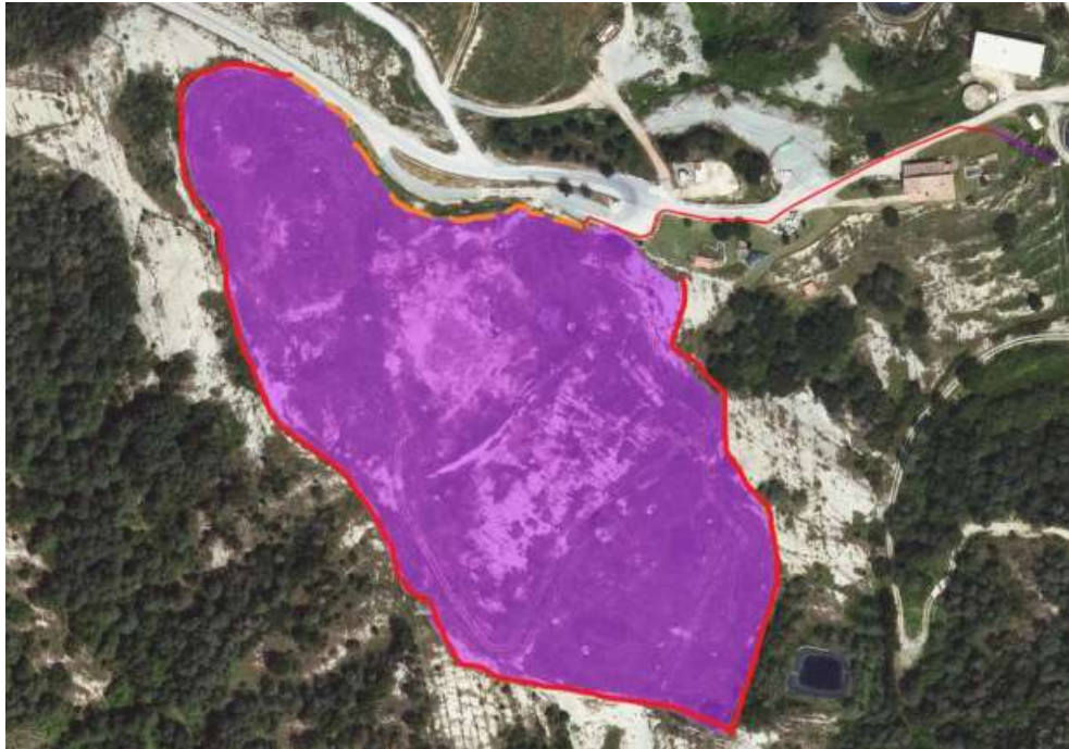
Fig. 1: Disposició de com ha de ser el tancament perimetral. La línia contínua vermella es correspon al tancament permeable i la discontinua taronja al tancament impermeable per a la fauna.
