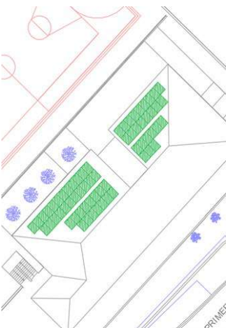
Figura 3 Implantació dels panells FV
