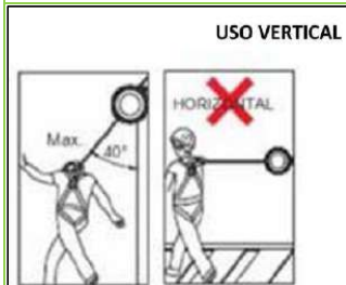
Figura 7. Ejemplo posicionamiento incorrecto dispositivo retráctil
