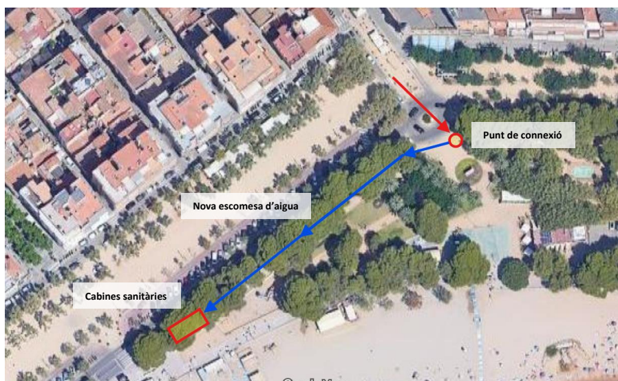
Punt de connexió per aigua potable i emplaçament cabines sanitàries
