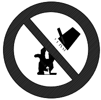
PROHIBIT APAGAR AMB AIGUA
