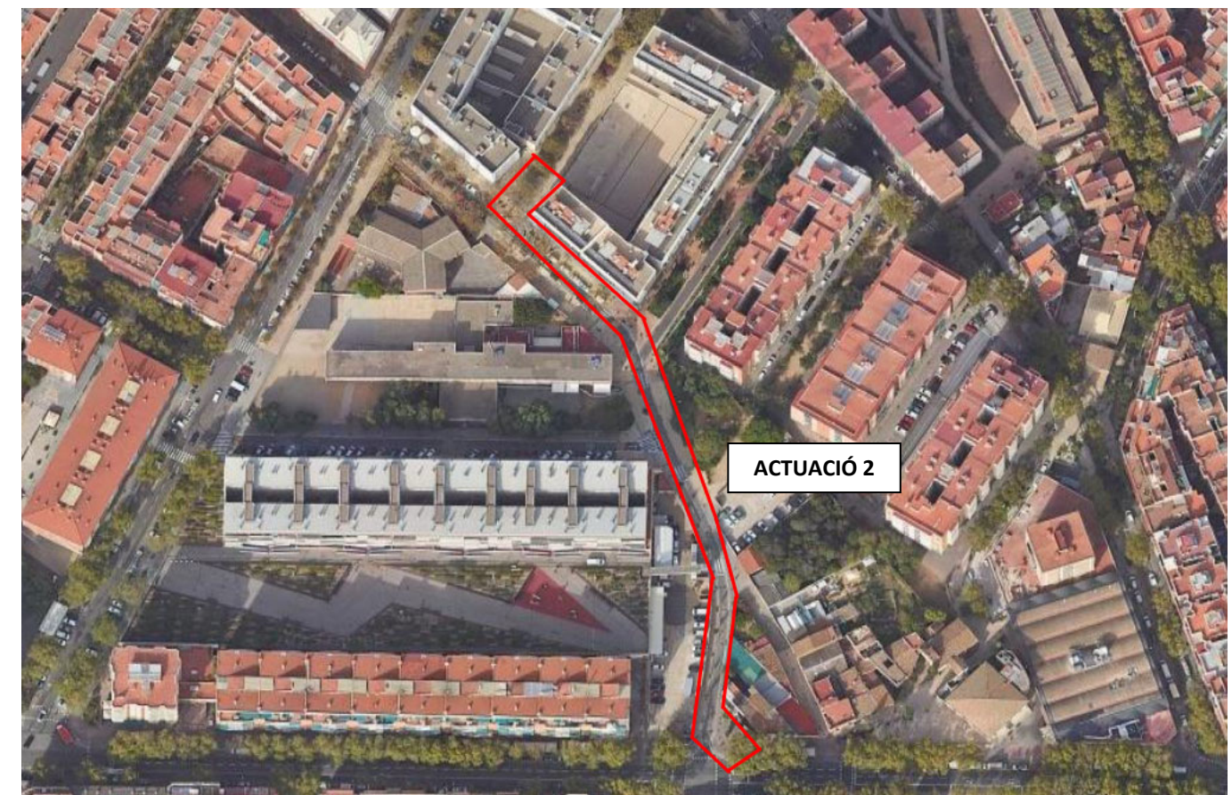
Actuació 2: Nova canalització a vorera de tipus 4c125 des del pericó existent PE11 fins al nou pericó PE16
