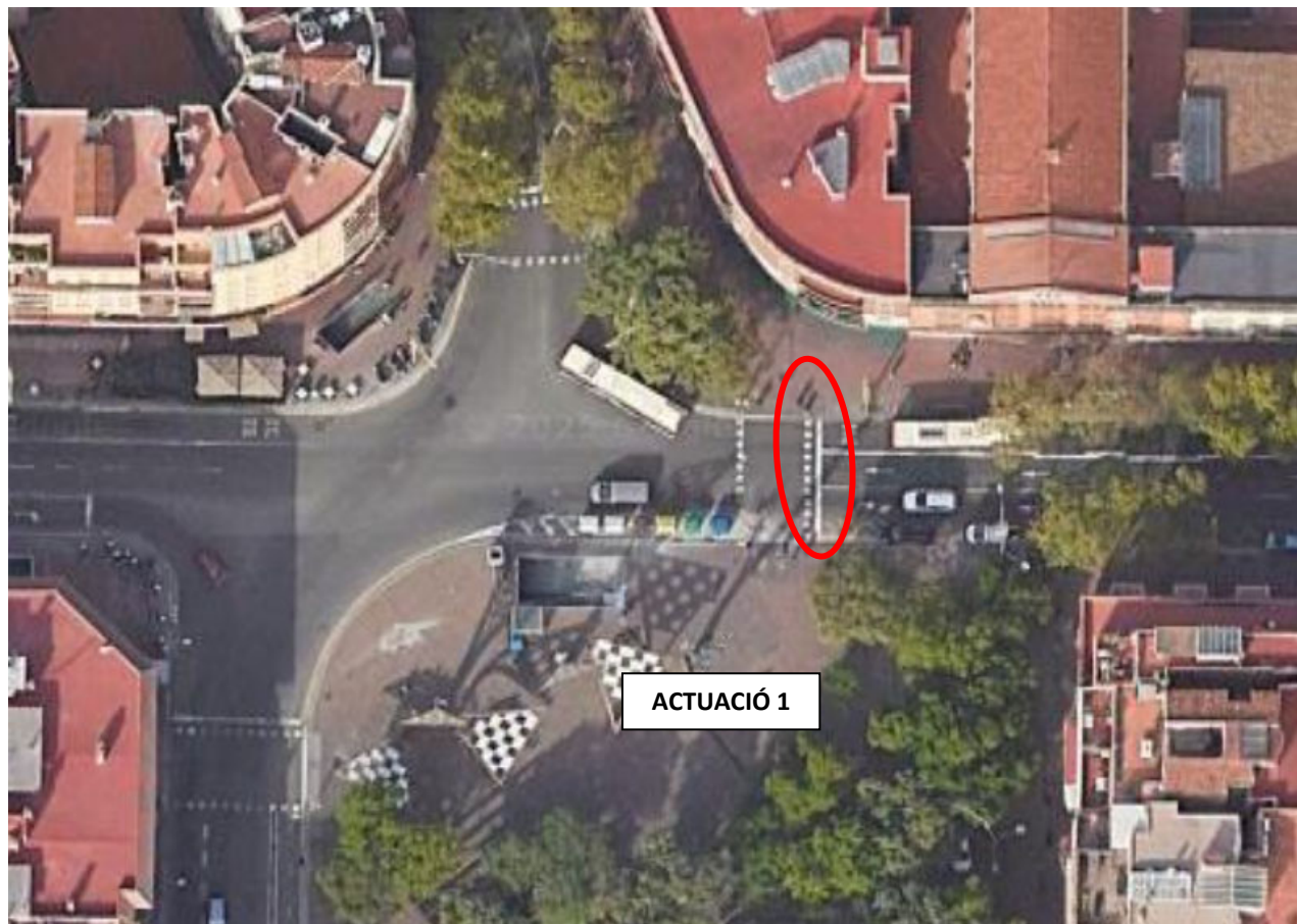
Actuació 1: Nou creuament a calçada de tipus 4c125 situat al Carrer Petrarca des del nou pericó PE04 fins al nou pericó PE05.
