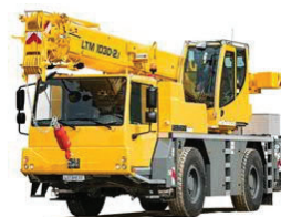
Figura 6: Donat que les encavallades tenen un pes reduït, es podran hissar amb grues de petites dimensions
