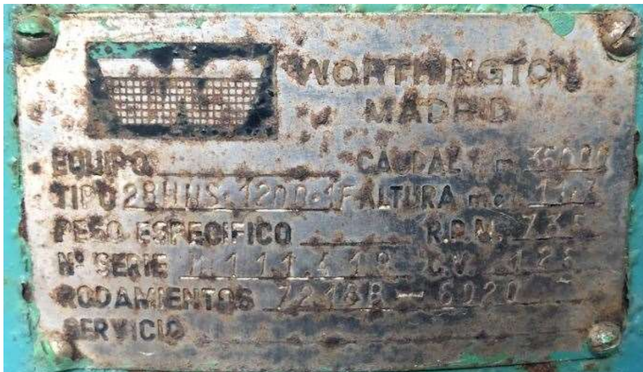
Figura 22. Placa identificadora bombes de rentat dels filtres de sorra nous
