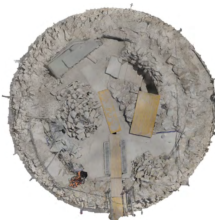
Ortofotogrametria del terrat, i de les façanes de la Torre, un cop eliminats els elements degradats del revestiment. 2024
