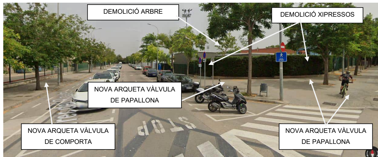
Foto 13.- Vista exterior de l'estació de tractament, on es pot observar dues seccions dels xipressos i un plataner que seran eliminats degut a que ocupen la zona de sortida de l'aigua tractada, per connectar a la xarxa d'aigua potable existent mitjançant dues sortides. També es poden observar les noves arquetes: 2 vàlvules de papallona i 1 de comporta, que estaran localitzades al exterior. Font: Street View, Google Maps
