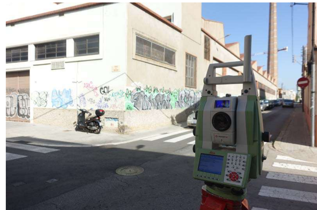
Aixecament topogràfic amb estació total
