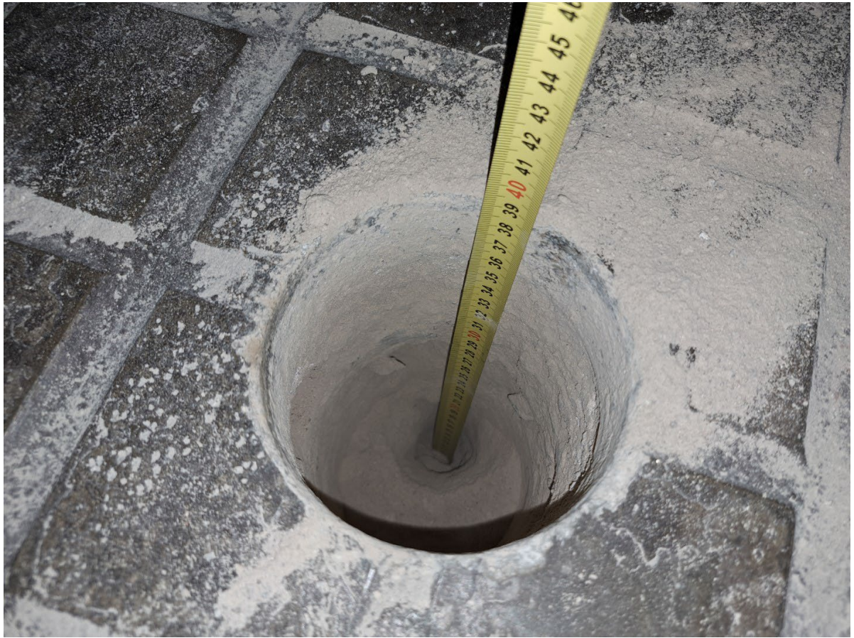
Foto 5. Mateixa composició en tota perforació. Armat llis a 15cm de profunditat
