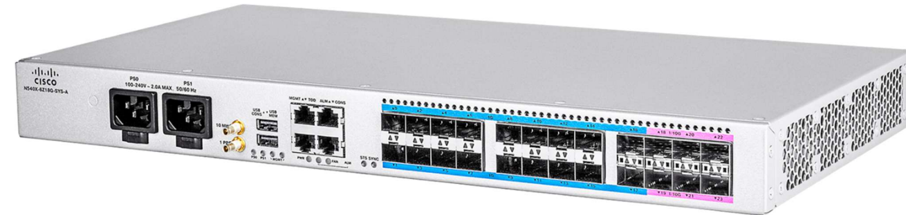
Il·lustració 12: Router MPLS Cisco N540X-6Z18G-SYS-A
