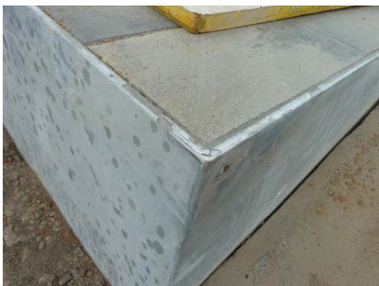
Arestes "arrodonides" a taller abans de galvanitzat, evitant punxes o fils que tallin, per pletines i vores.
