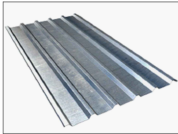
Coberta amb perfil nervat de planxa d'acer galvanitzada i lacada, d'alçaria 44mm i d'1,2mm de gruix
