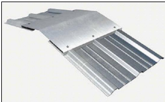
Figura 15. Carener de xapa d'acer galvanitzat precat, d'1mm de gruix, 60 cm de desenvolupament i amb junt d'estanquitat.
