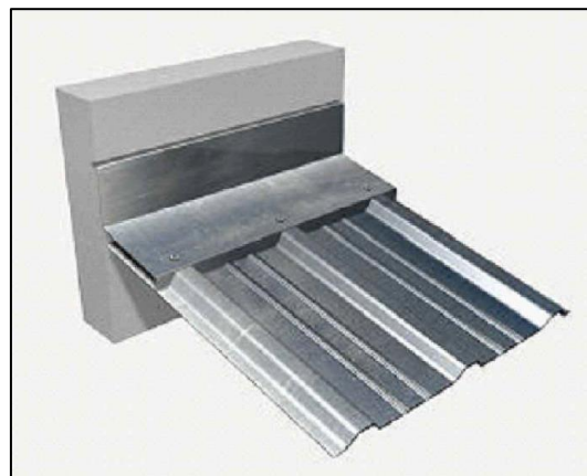
Figura 18. Trobada frontal o lateral amb xapa d'acer galvanitzat prelacat, d'1mm de gruix i amb junt d'estanquitat.
