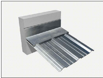
Trobada frontal o lateral amb xapa d'acer galvanitzat prelacat, d'1mm de gruix i amb junt d'estanquitat
