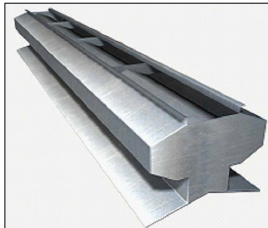
Figura 16. Airejador lineal estàtic, de xapa d'acer galvanitzat, de 35cm de longitud, 60cm d'amplada i 0,6 mm de gruix.
