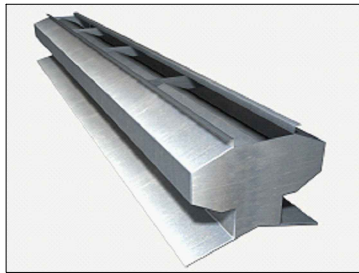
Airejador lineal estàtic, de xapa d'acer galvanitzat, de 35cm de longitud, 60cm d'amplada i 0,6 mm de gruix
