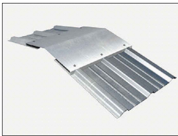
Carener de xapa d'acer galvanitzat prelacat, d'1mm de gruix, 60 cm de desenvolupament i amb junt d'estanquitat
