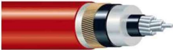
* Conductor RH5Z1 18/30 kV 3x240mm² Al
