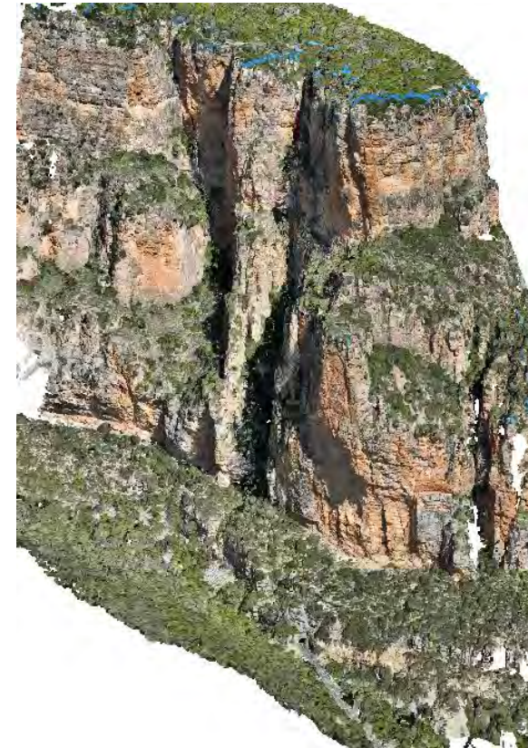
Figura 1. Model fotogramètric 3D elaborat a partir del vol amb RPAS.
