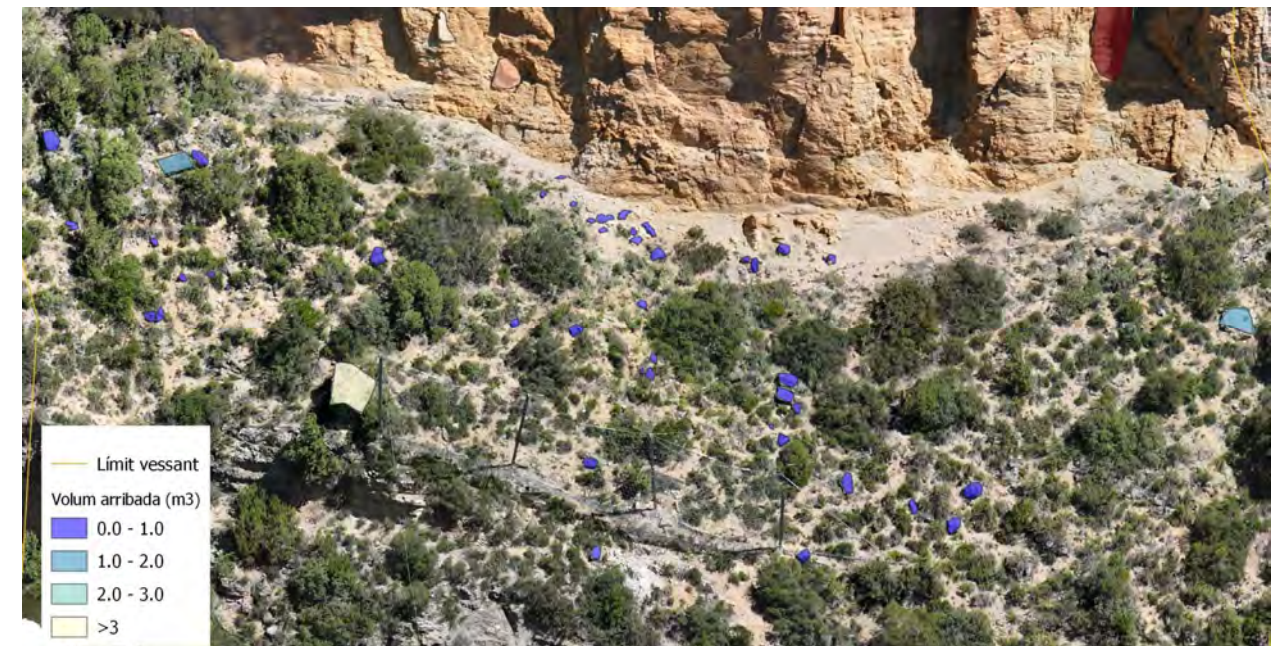
Figura 11. Comptatge dels blocs d'arribada presents al peu del vessant.
