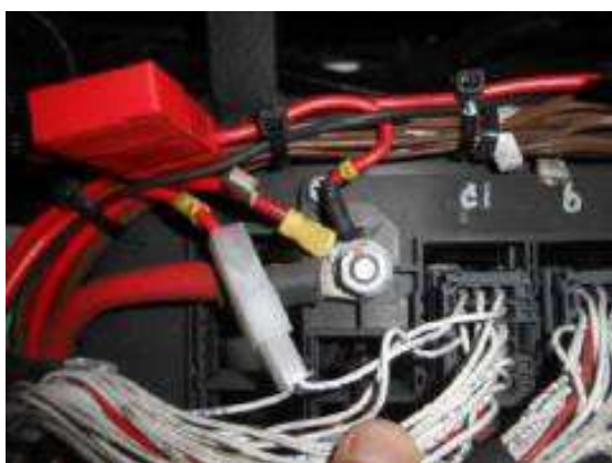
Figura 6: Detalle instalación fusible aéreo
