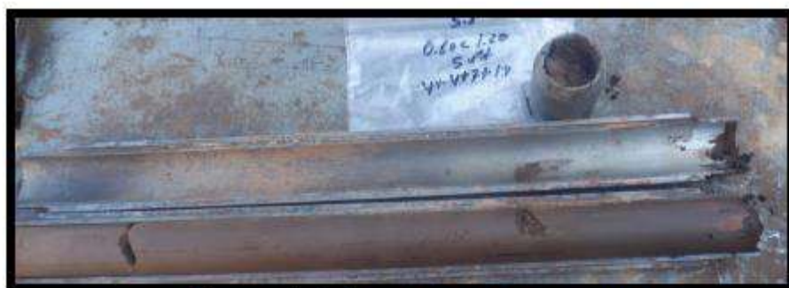
Aspecte dels materials de la capa A, recuperats a un assaig SPT.
