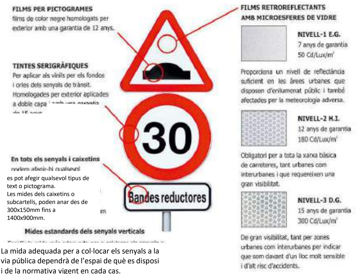
Figura 127. Característiques tipus senyals verticals part frontal.
