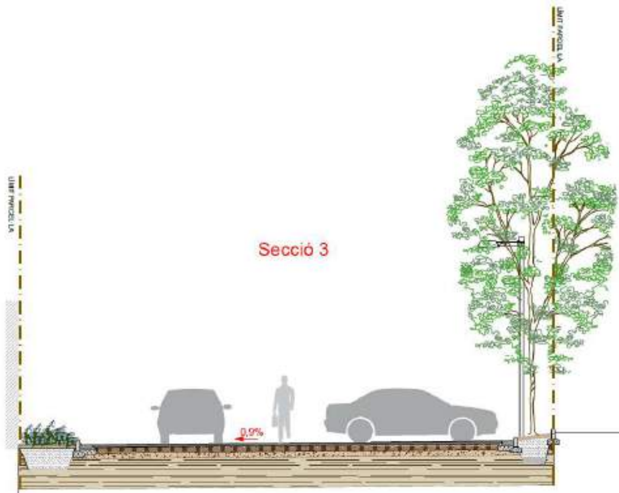
Figura 32. Secció transversal aparcament. Número 3.
