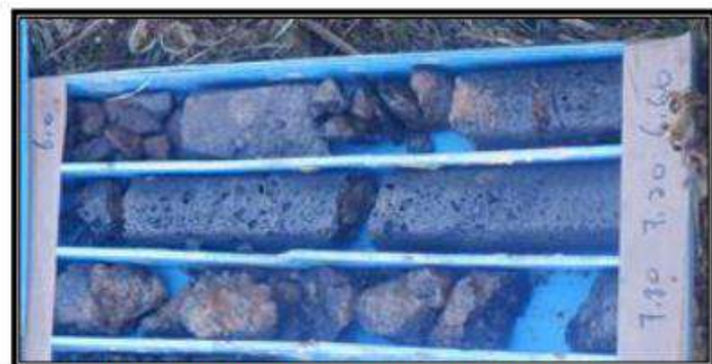
Aspecte dels materials de la capa B, recuperats al sondeig.
