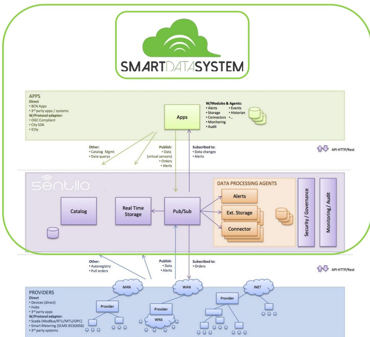
La información adquirida por la SENTILO es almacenada en un servidor propiedad de SMARTDATASYSTEM. El sistema es completamente abierto y escalable tanto vertical como horizontalmente.
