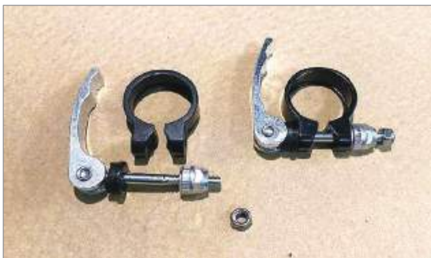
Imatge codi BICI037: Tanca tipus abraçadora \varnothing 28,6 mm.
