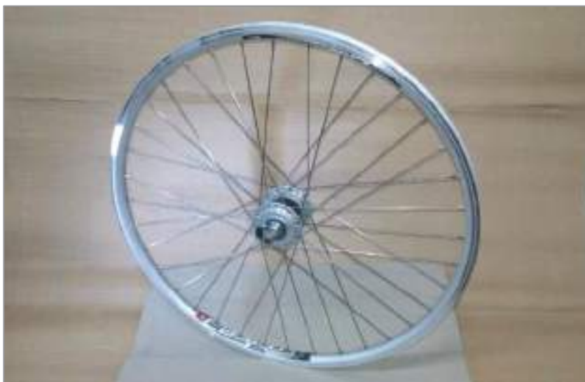
Imatge codi BICI002: Llanta davantera amb dinamo
