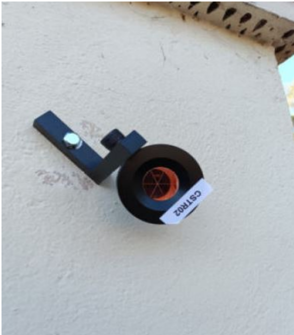
Fotografia del tipus de prisma instal·lat
