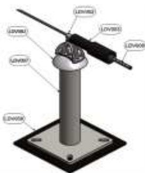
Fig. 2 Configuración de anclaje terminal
