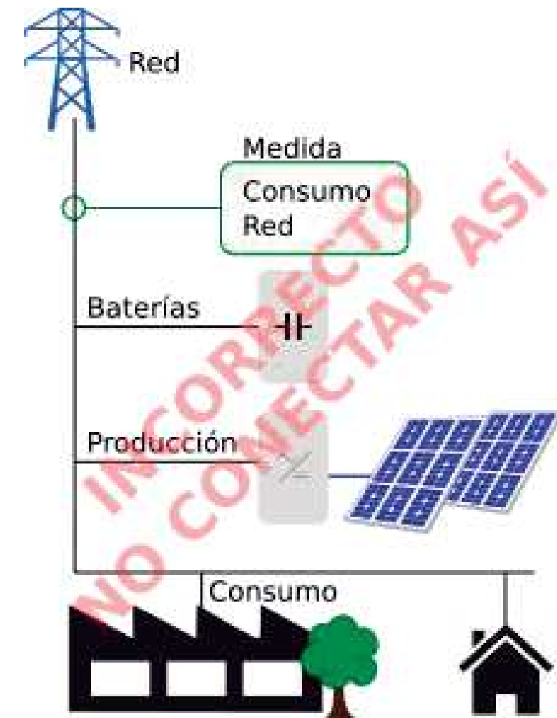
Figura 6: Esquema INCORRECTO conexión baterías
