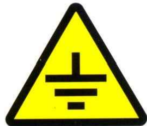
PERILL PRESA DE TERRA
