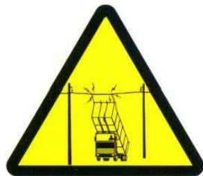
PERILL LÍNIA ELÈCTRICA ÀREA
