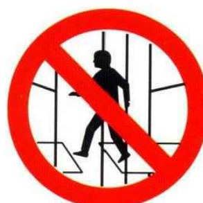
PROHIBIT EL PAS BASTIDA INCOMPLERTA
