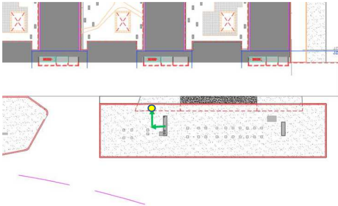
Imatge 68. Traçat cablejat CC per baixant i planta baixa edifici Gerència
