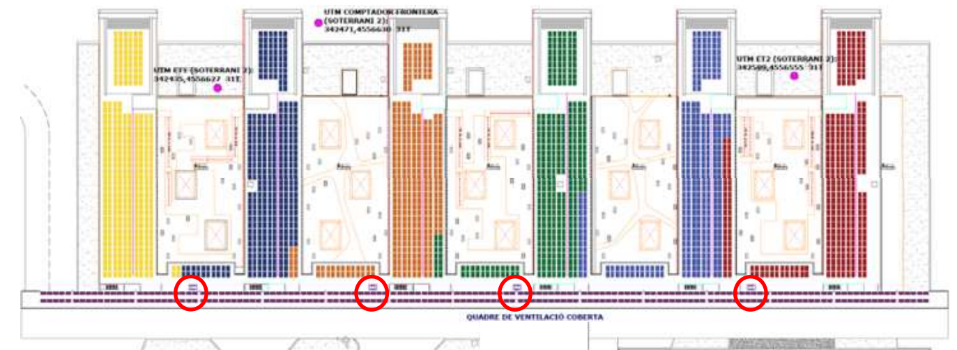
Imatge 77. Localització inversors de 6 kW a coberta
