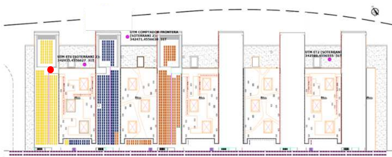
Imatge 48. Mòduls fotovoltaics connectats a la ET1
