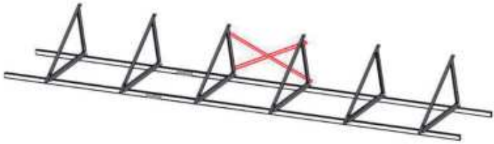
Figura 5. Detalle posicionamiento riostras
