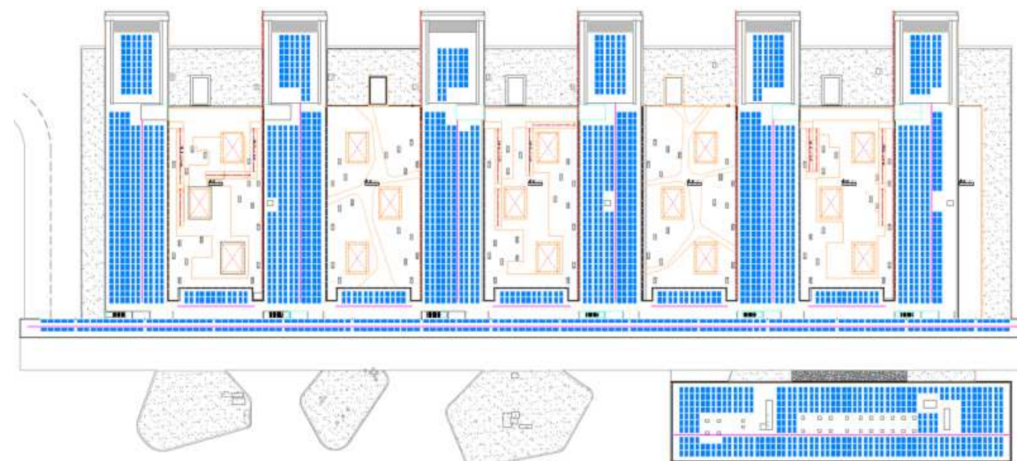
Imatge 99. Emplaçament línies de vida a coberta
