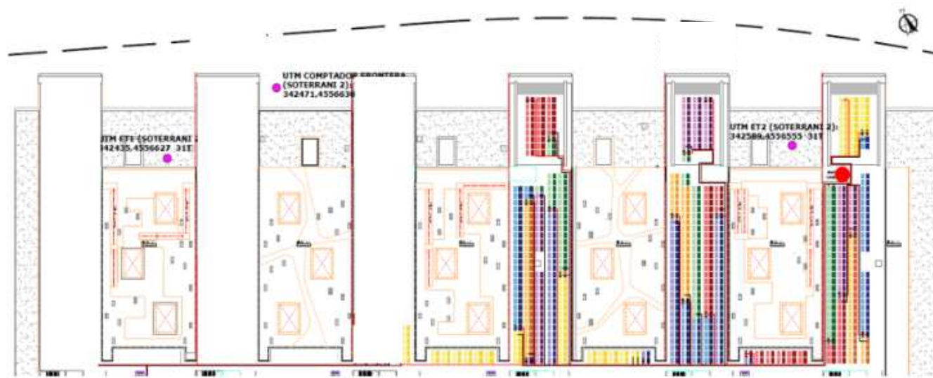
Imatge 60. Mòduls fotovoltaics sobre espines E, D i F connectats a la ET2
