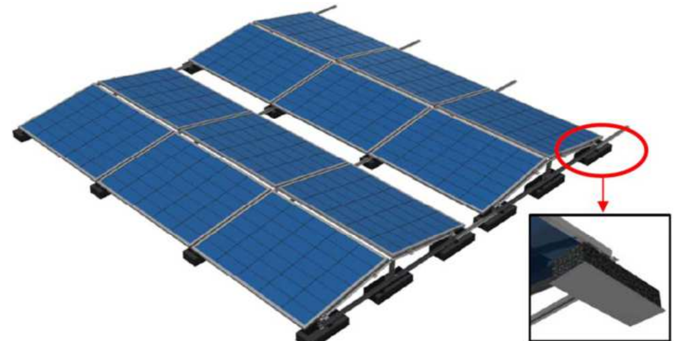
Imatge 33. Detall vista 3D del conjunt i detall EPDM
