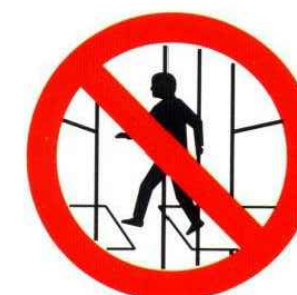
PROHIBIT EL PAS BASTIDA INCOMPLERTA
