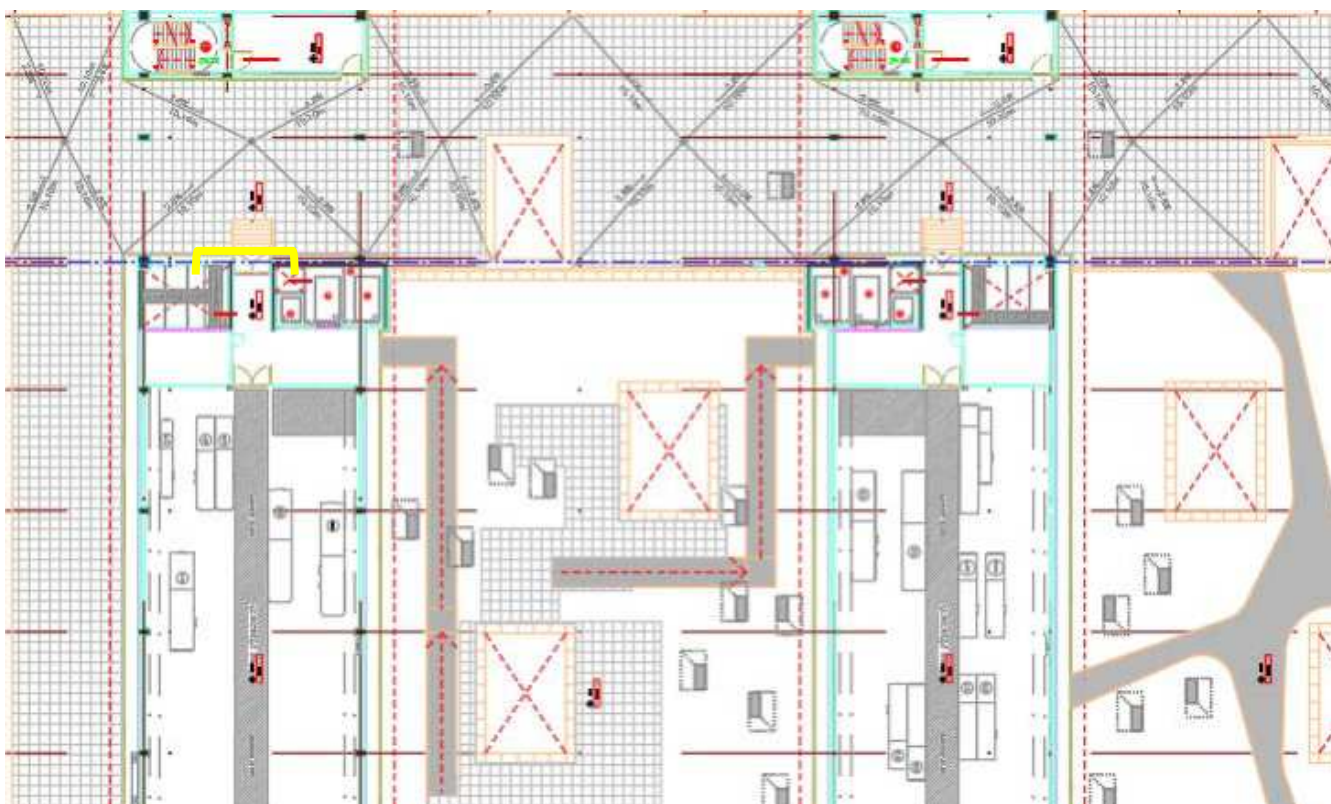
Imatge 53. Pas de cablejat en groc a planta tècnica de un baixant a l'altre Espina A
