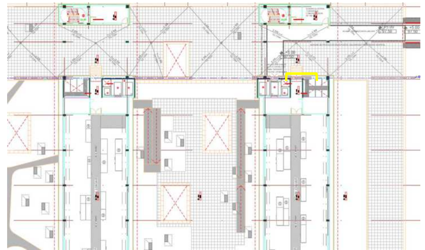
Imatge 62. Pas de cablejat en groc a planta tècnica de un baixant a l'altre Espina F
