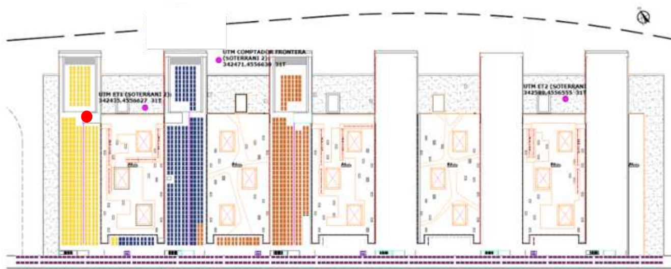
Imatge 48. Mòduls fotovoltaics connectats a la ET1
