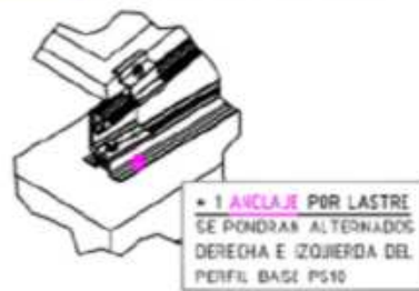
DETALLE A (NVE) NUDO DELANTERO PRIMER SOPORTE ENRASADO CON EL PERFIL BASE PS10
