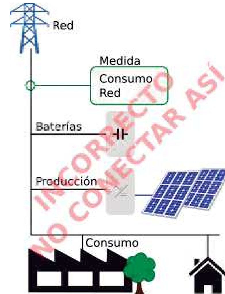
Figura 6: Esquema INCORRECTO conexión baterías
