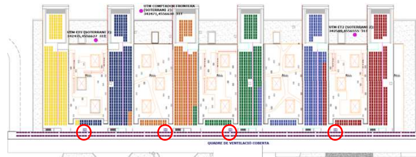
Imatge 77. Localització inversors de 6 kW a coberta
