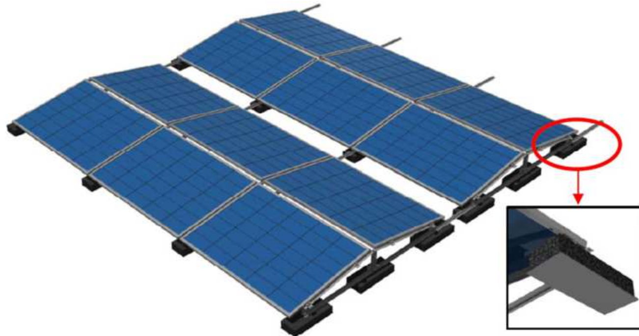
Imatge 8. Detall vista 3D del conjunt i detall EPDM
