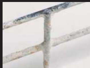
Acabado galvanizado en caliente estándar después de 600 horas Standard hot dip galvanized finish after 600 hours
