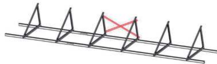
Figura 5. Detalle posicionamiento riostras
