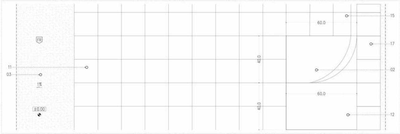
DETALL D'ACCÉS VEHICULAR. TROVAMENTSOLERA EXTERIOR PER INGRESO DE CAMIONS DE 25CM AMB VORERA.
