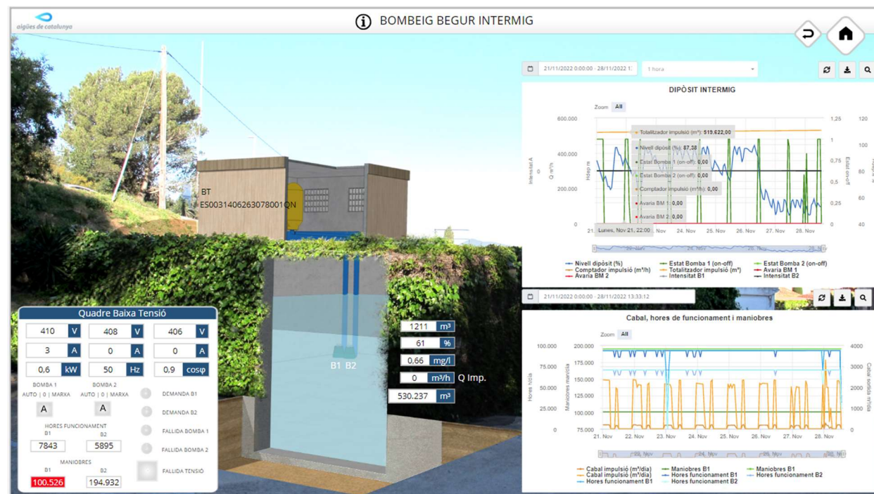
Imatge 8. Telecontrol dipòsit Begur Intermig
