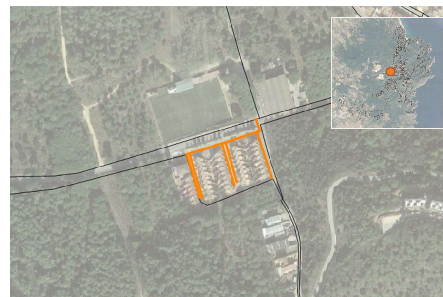
Imatge 64. Renovació xarxa aigua potable Les Arenes
