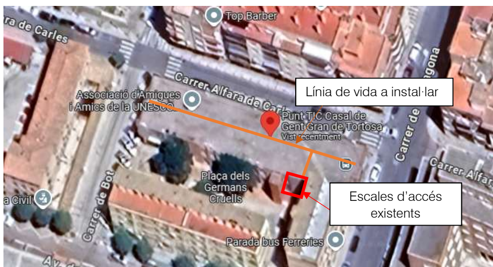
Figura 25 Proteccions col·lectives i accessos durant la fase d'execució.
