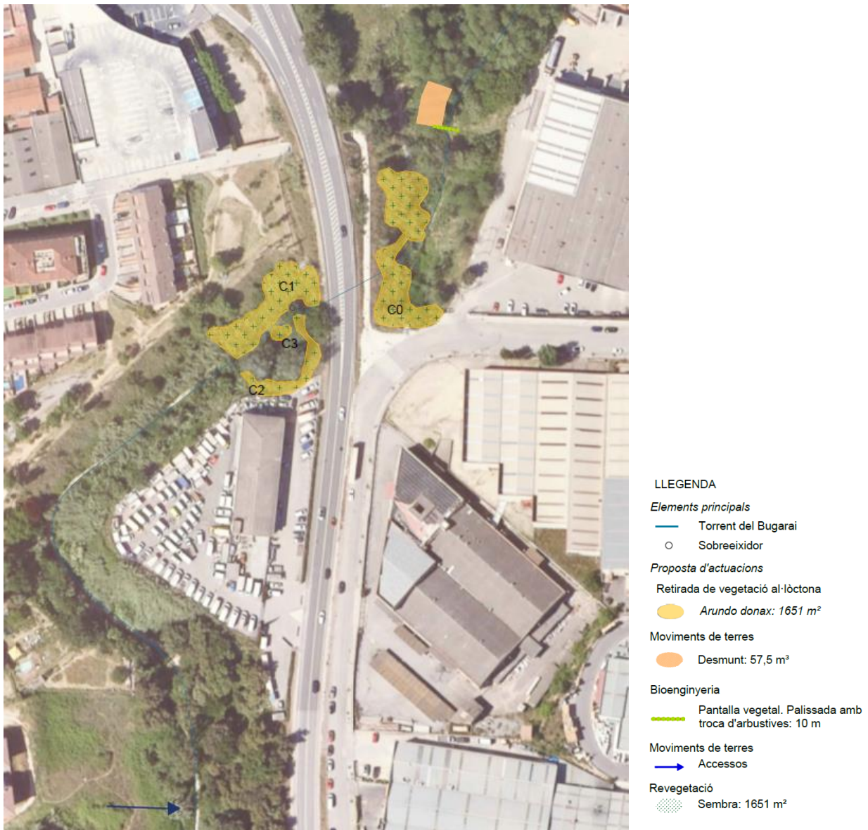
Figura 9 Plànol de retirada d'elements i eliminació d'espècies al·lòctones
