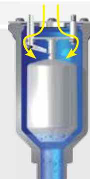
Admisión de grandes cantidades de aire durante el vaciado.
