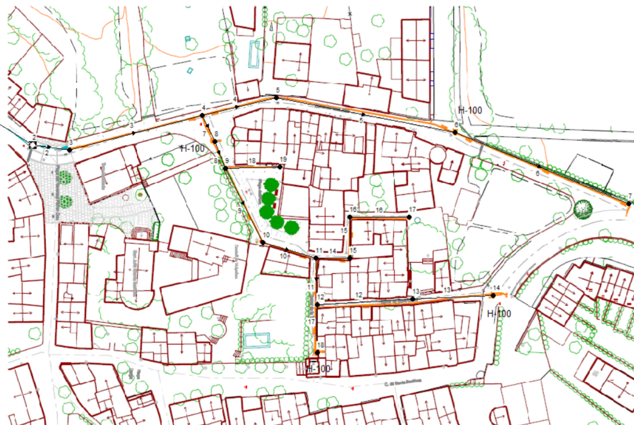
Figura 1: Esquema de la xarxa de subministrament d'aigua amb el plànol base
