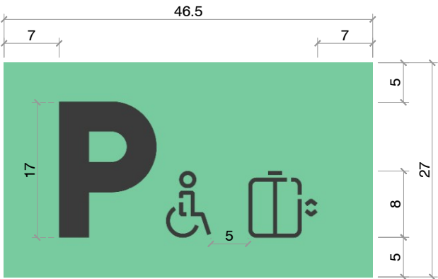
S-RE24 (Model 2) Vinil "Tipus acés" sobre xapa metàl·lica galvanitzada - Proposta
