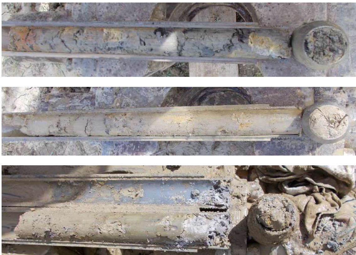
Mostres recuperades al tercer sondeig, corresponen a materials reblerts molt tous
