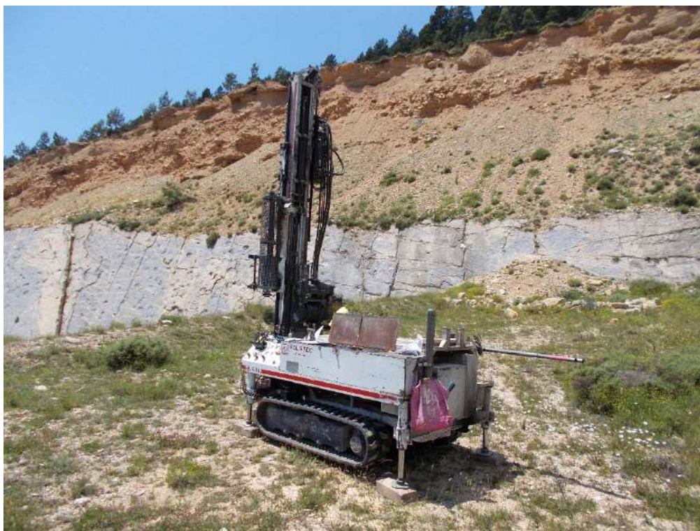
Detall del primer sondeig (PI6), les mostres recuperades tipus SPT i l'aflorament just a sota on s'observen les capes tallades al sondeig
