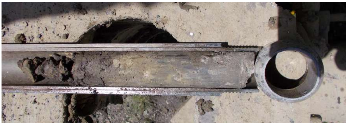
Mostra tipus SPT extreta al sondeig S5, a 1m de profunditat. Replens
