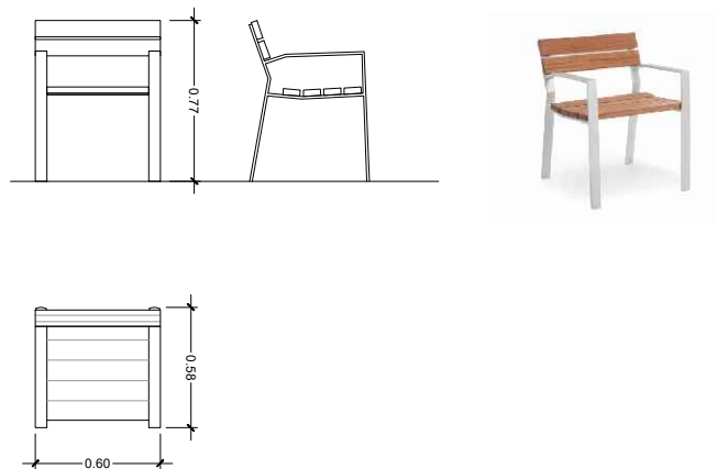
CADIRA DE 6 LLISTONS DE FUSTA DE PI TERMOTRACTAT PEFC PROTEGITS AMB OLI I ESTRUCTURA DE POTES DE FOSA D'ALUMINI ACABAT ANODITZAT. - 3UTS
