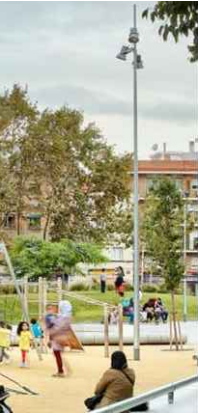
L-3 LLUM CAMÍ COLUMNA D'ENLLUMENAT TELESCÒPICA TIPUS LED AMB 3 PROJECTOR DE 8m D'ALÇADA
