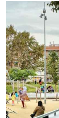
COLUMNA D'ENLLUMENAT TELESCÒPICA TIPUS LED AMB 3 PROJECTOR DE 8m D'ALCADA
