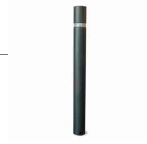
PILONA DE POLIPROPILET TIPUS BARCELONA DE Ø 100X 996 MM D'ALÇADA, AMB ARGOLLA REFLECTANT. AMB UN ANGLE DE FLEXIÓ MÀXIM DE 20° I DE COLOR GRIS TIPUS FORJA.
