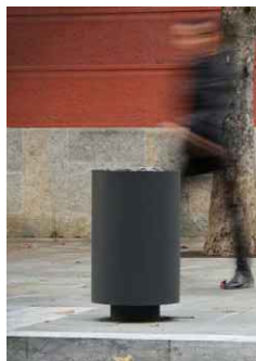
PAPERERA DE XAPA (3MM) D'ACER GALVANITZAT I PINTAT AL FORN. CÈRCOL EN ACER INOXIDABLE. FIXACIÓ MITJANÇANT PERNS. -10 UTS
