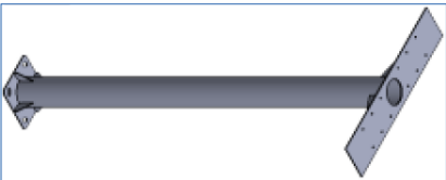
Il·lustració 10. Columna model centrada
