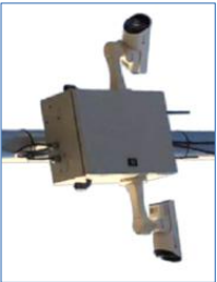
Il·lustració 6. Exemples d'unitat de lectura de matrícules amb una carcassa
