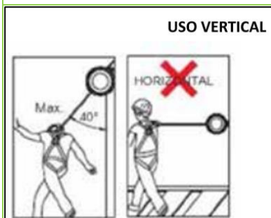
Figura 7. Ejemplo posicionamiento incorrecto dispositivo retráctil
