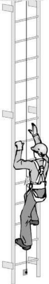
escalera fija > 7 m.
