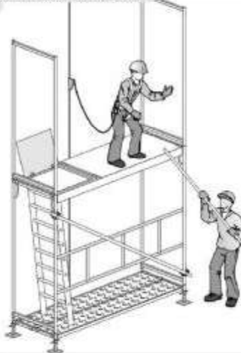
armado de andamio
