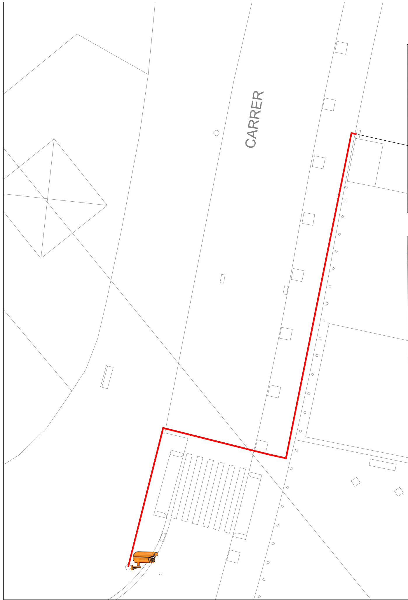
DETALL SITUACIÓ CAIXA Schneider NSYPLSP3636G o similiar dins QUADRE QM080
