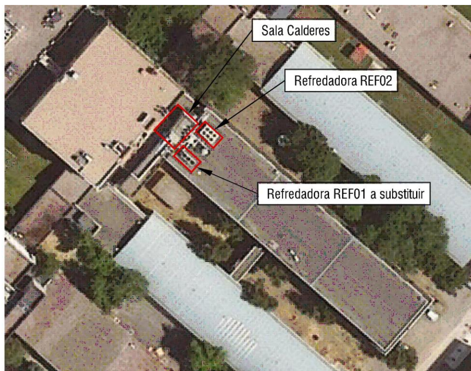
Fig. 1. Ubicació a coberta sala calderes i refredadores
