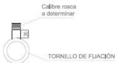
EL TORNILLO DE FIJACIÓN SE COLOCARÁ EN LA PIEZA 5 ( CAJA LÁSER) Y EN LA PIEZA 6 ( SOPORTE LÁSER) ANTES DEL MONTAJE DE DICHAS PIEZAS.
