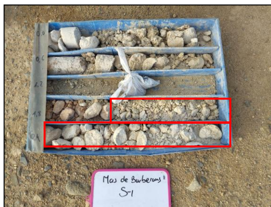
Imatge 4-2 En el requadre vermell el nivell A. Substrat alterat a argiles margoses ocre.
