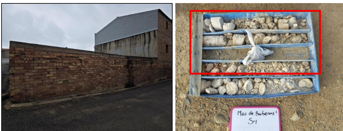
Imatge 4-1 Vista de la parcel·la i a la dreta en el requadre vermell el nivell 0 de reblert heterogeni,
