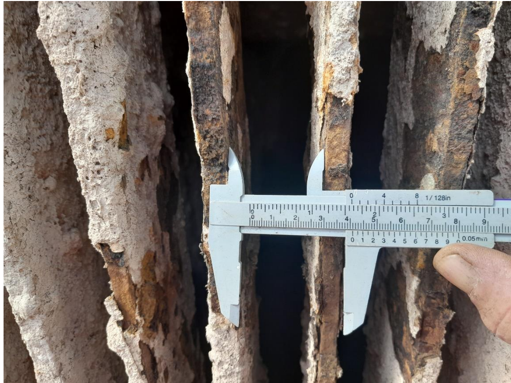
Fotografia 17 Pas de reixa de 4 cm S'observa l'estat de la reixa amb incrustacions.(Reixa esquerra)
