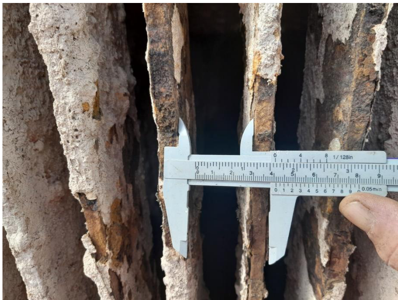
Fotografia 2 Pas de reixa de 4 cm S'observa l'estat de la reixa amb incrustacions.(Reixa esquerra)
