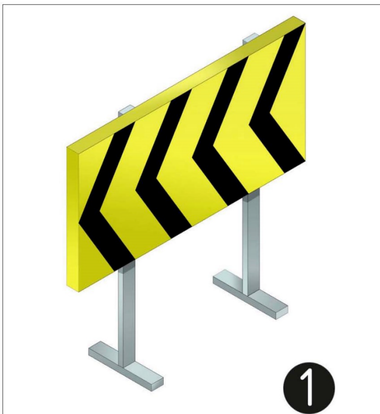
1. plafó desviament de trànsit
